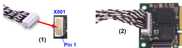
Abbildung 4: Kabel in den Kabelstecker Ethernet auf der Grundkarte stecken, Beispiel CIFX HPCIE90
