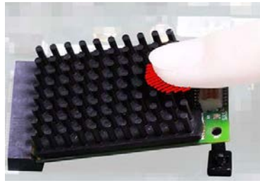
Abbildung 52: Grundkarte mit leichtem Druck (max. 2 N) herunterdrücken (Beispiel)
