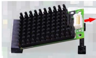
Abbildung 62: PC-Karte cifX aus dem Mini PCI Steckplatz entnehmen
