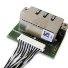
Abbildung 57: Abgesetzte Netzwerkschnittstelle Ethernet (AIFX-RE) an die Grundkarte CIFX 104C-RE\F anschließen (Beispiel)
