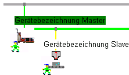
Abbildung 70: Beispiel Debug-Modus mit anstehender Diagnose, Netzwerkdarstellung eines Projektes mit einem Netzwerk (Master und Slave)
