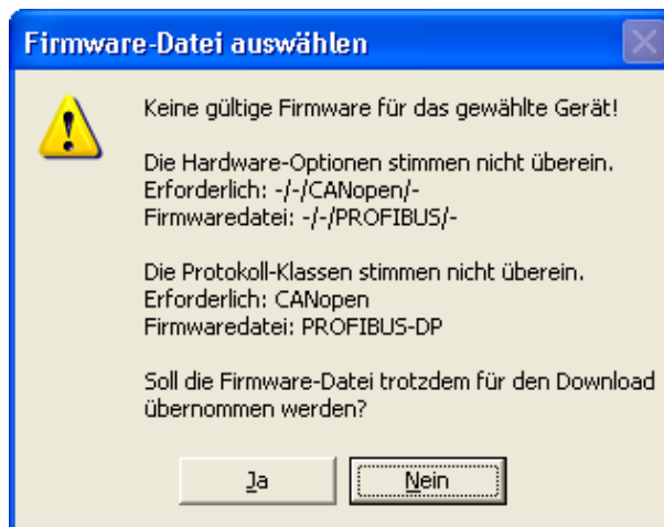
Abbildung 17: Abfrage Firmware-Datei auswählen – Beispiel Keine gültige Firmware
