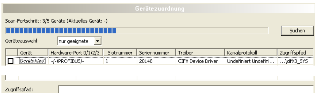
Abbildung 10: Gerätezuordnung - erkannte Geräte (Beispiel: Gerät ohne Firmware)
