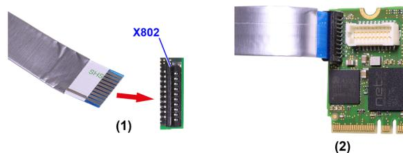
Abbildung 5: Kabel an Grundkarte anschließen, Beispiel CIFX M223090AE
