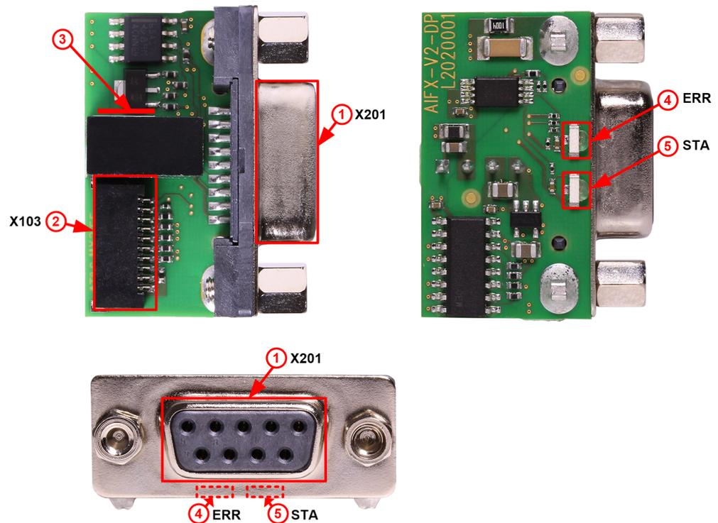
Abbildung 2: Abgesetzte Netzwerkschnittstelle AIFX-V2-DP (Revision 2)
