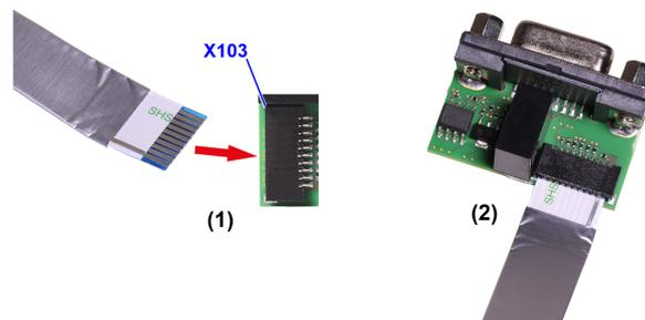
Abbildung 4: Kabel an abgesetzte Netzwerkschnittstelle PROFIBUS AIFX-V2-DP anschließen
