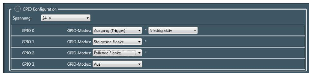
Abbildung 24: Konfiguration der Mehrzweck-Ein- und Ausgänge (GPIO)
