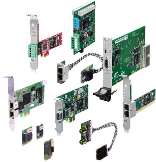
Hilschers PC-Karten cifX sind der einfachste und schnellste Weg PC-basierte Automatisierungsgeräte mit einer Feldbus- oder Real-Time-Ethernet Schnittstelle auszustatten. Über ladbare Firmware wird der Protokollstack autark auf der PC-Karte abgewickelt und der Datenaustausch zum Host erfolgt per Dual-Port-Memory oder DMA (Direct Memory Access). Gemeinsam mit am Markt erhältlichen SoftPLCs, Visualisierungen oder eigenen Applikationen lösen sie in kürzester Zeit nahezu jede Automatisierungsaufgabe.
